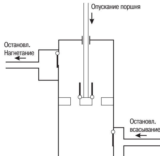
Рисунок 13. Вторая фаза: опускание поршня, переход предварительно всосанной жидкости на нагнетание
