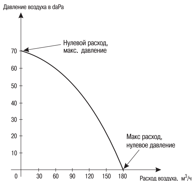
Рис. 103 Кривая расход-давление вентилятора
